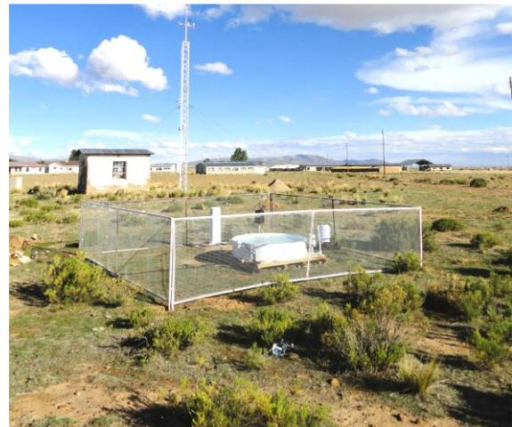
Fig. 1. La estación meteorológica de Patacamaya, en primer plano los sensores de evaporación y precipitación. Al fondo la torre con los sensores principales, la caja de control y la caseta de monitoreo.
